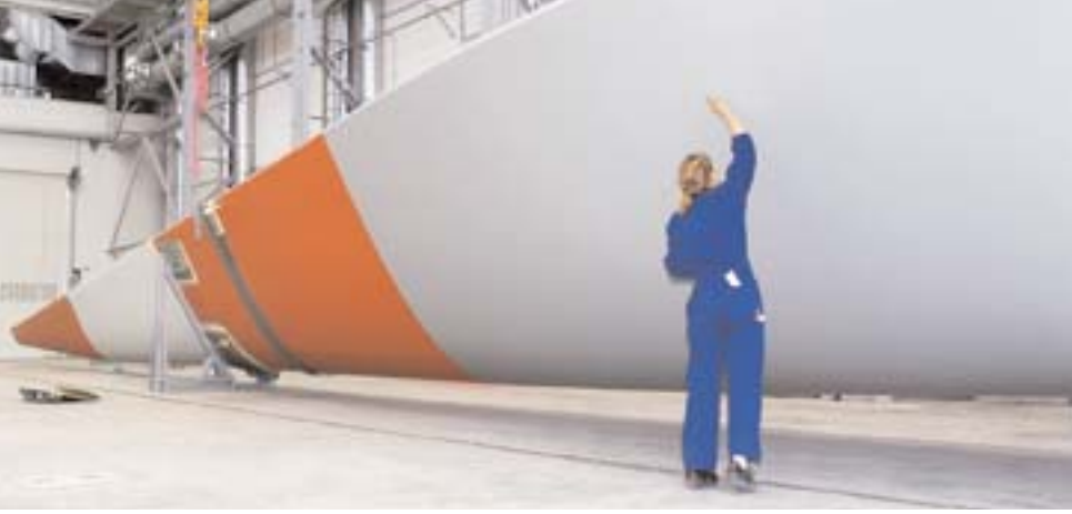
Bereit für den Wind: Letzte Arbeiten an einem 32 Meter langen Rotorblatt
